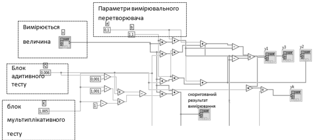
Рис. 2.4 Модель вимірювального каналу при застосуванні тестового методу
