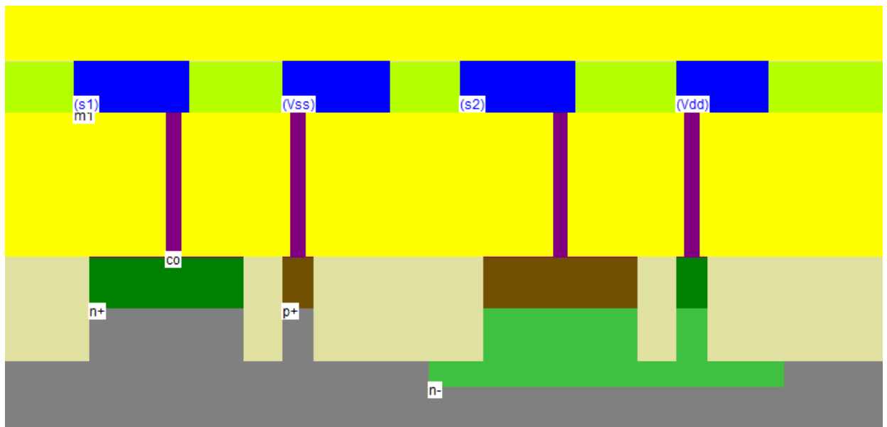
Рис 3.2. Поперечні перерізи діодів N + / P- та P + / N +КМОН конденсатор nMOS і pMOS типу
