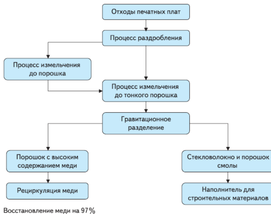
Рис. 7.4.2. Утилізація відходів з використанням процесу дроблення
