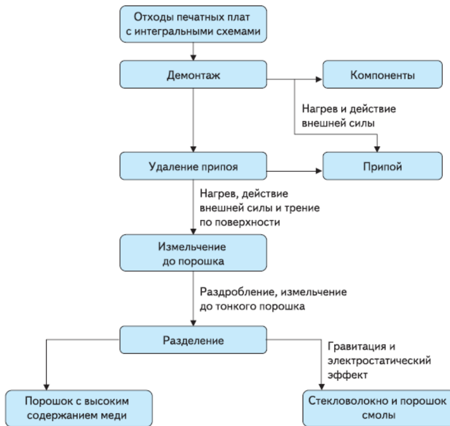
Рис. 7.4.3. Схема утилізації плат з компонентами за технологією SAT
