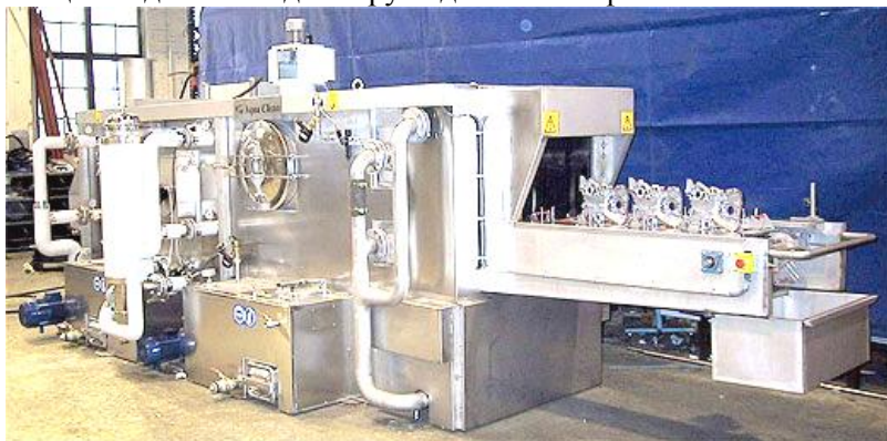
Рис. 3.15. Тунельна мийна машина фірми Sampo-Roserwel для очищення вузлів трансмісії
