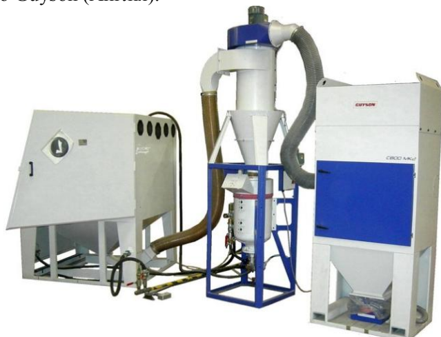
Рис. 3.16. Лінія піскоструменевої обробки великих деталей автомобіля
