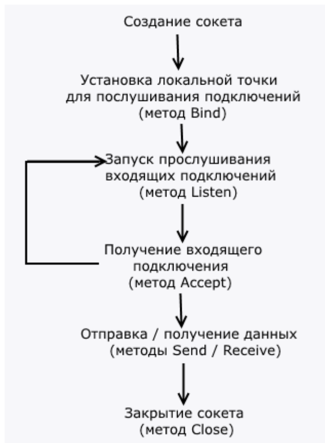
Рис. 3.4. Загальна схема роботи серверного сокету TCP
