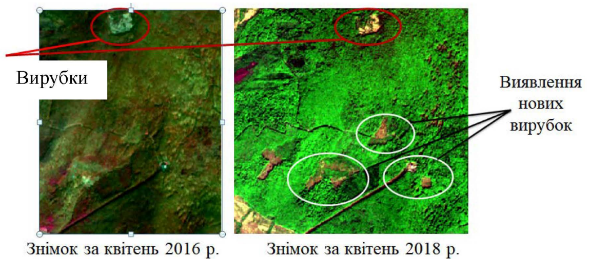
Рис. 3.24. Виявлення нових вирубок лісів за допомогою дослідження різночасових знімків
