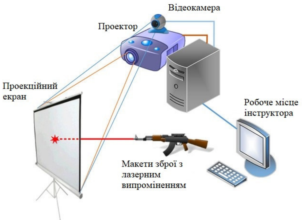
Рис. 1.2. Принцип роботи лазерного стрілецького тренажеру
