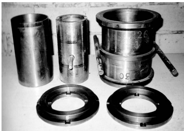
Рис. 11.2. Комплект прес-форм для виготовлення фільтроелементів
