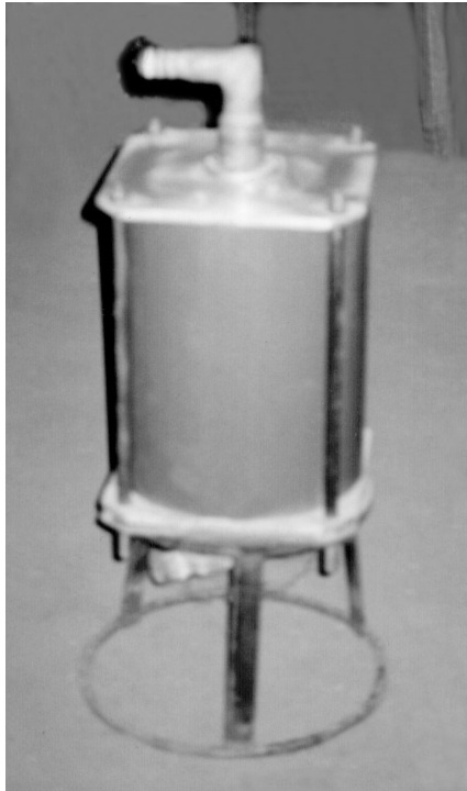
Рис. 12.1. Дослідний зразок полімербетонного фільтра
