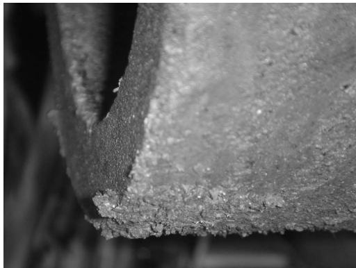
Рис. 12.6. Фрагмент забрудненого полімербетонного фільтроелемента
