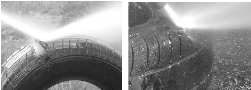
Рисунок 3.4. Взаємодія гідроабразивного струменя з по верхнюю шини: а) взаємодія з „біговою доріжкою”; б) взаємодія з бортом шини
