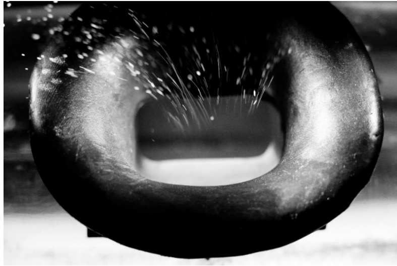
Рис. 2.16 Візуалізація течій у вхідному соплі вихрової камери з використанням лемніскатного входу для випрямлення епюри швидкості вхідного потоку
