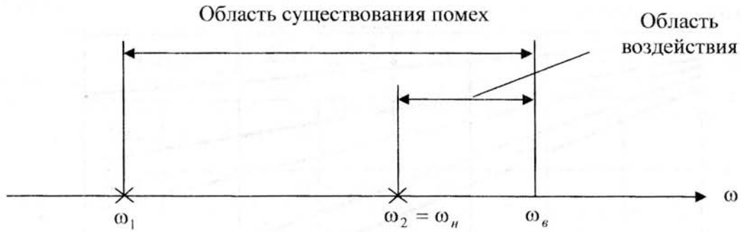
Рис. 2. Модель воздействия помехи по паразитному каналу приёма на пассивную информационную систему
