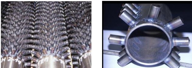
Рис. 1 – Фрагменти технологічних трубопроводів (з навареними шипами), перед кріпленням карбідокремнієвої футерованої маси
