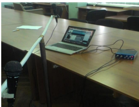
Рис. 5.16. Макет експериментального локатора з багатьма входами і одним виходом.
