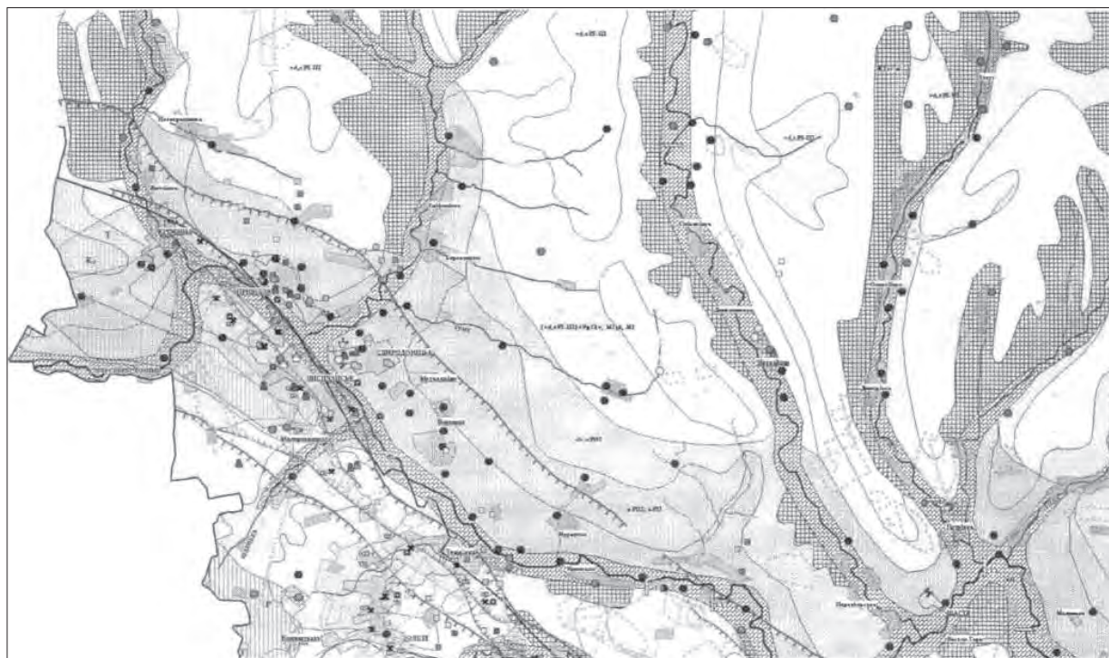
Рис. 2.15. Фрагмент карти зіставлення літологічного складу порід зони аерації підземних вод мергельно-крейдяного водоносного горизонту
