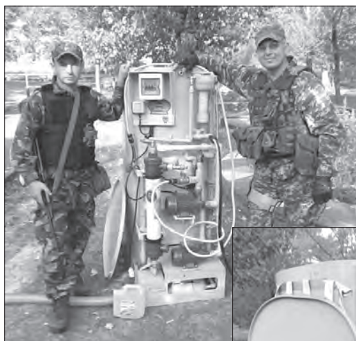
Рис. 4.7. Біоплато-біофільтр із закритим регенератором біодеструкторів-ензимів (Тип 6 фітотехнології ФРБГТ ДЕА)
