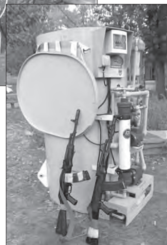
Фото 4.1. Загальний вигляд блок-елемента мобільної фільтрувальної установки (розробка на базі патентів України за участю ДЕА) для отримання питної води та води для госпіталів в польових умовах
