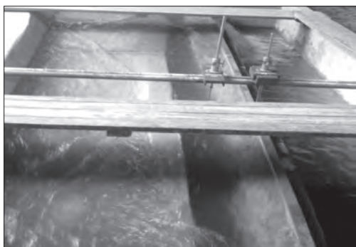
Фото 6.8. Лабораторні дослідження бокового водозабору протипаводкової акумулюючої ємкості «Тершаків» на р. Бистриця у Львівській області
