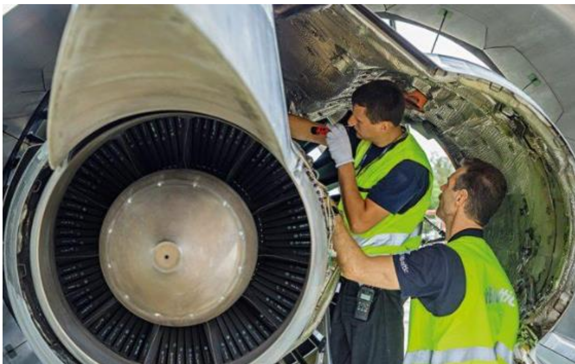
Мал.1.3. Візуальне виявлення пошкоджень та дефектів на агрегаті ПС.
