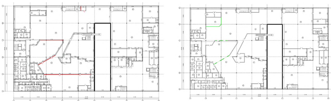
Рис. 35. План демонтажу та монтажу стін 2 рівня
