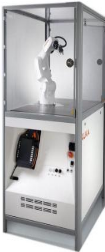
Рис.3.2. Зовнішній вигляд роботизованого осередку KUKA
