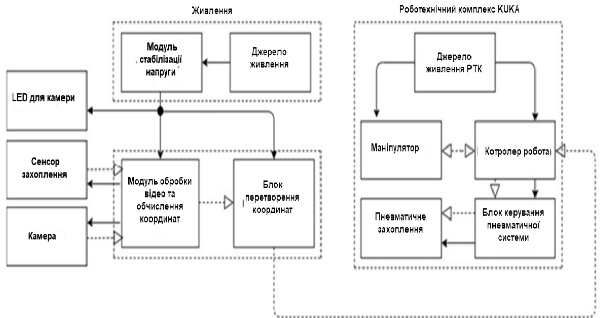
Рис.3.3 – Структурна схема комплексу із СТЗ
