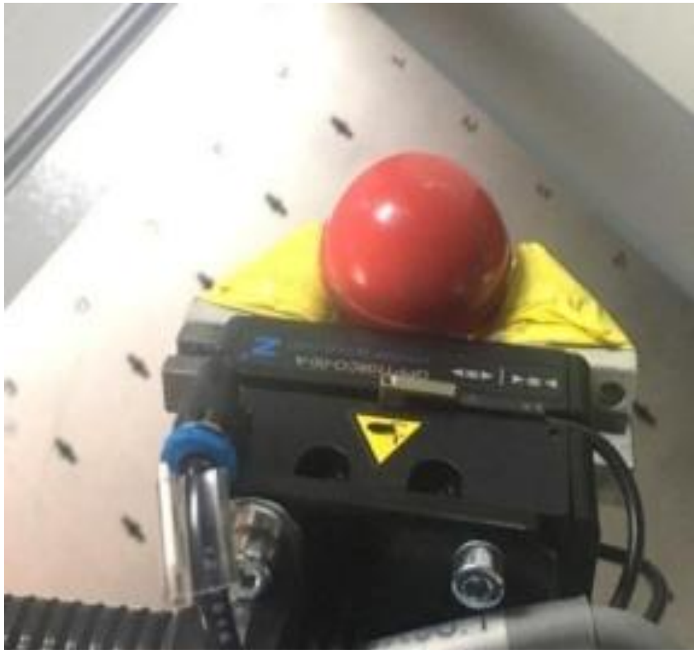
Рис.3.11. Захоплення об'єкта за допомогою маніпулятора (вид із камери)
