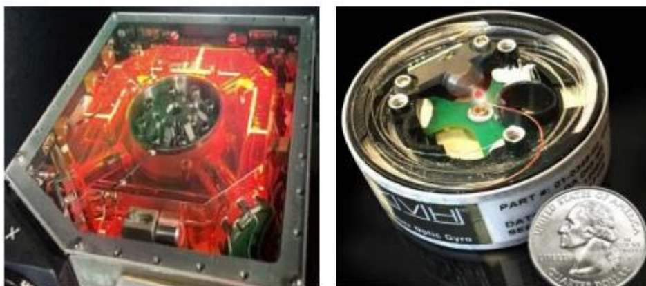
Рис. 2.2. Датчики кутової швидкості БІНС : а – кільцевий лазерний гіроскоп;
