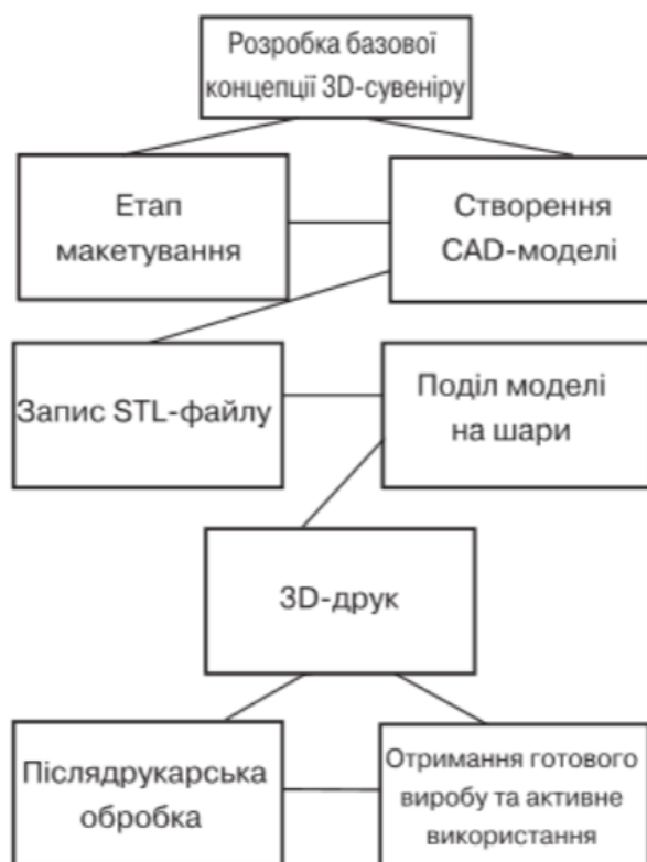
Рис. 2.2 Етапи виготовлення 3D сувенірного виробу [22]
