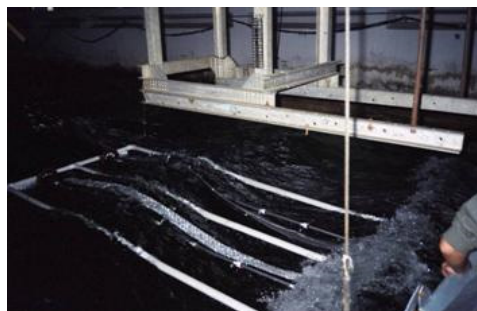
Рис. 1. Випробування макетів в хвильовому басейні, Інститут гідромеханіки НАН України
