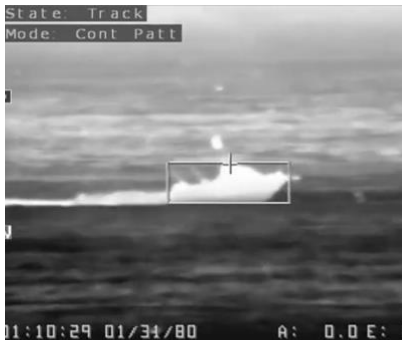
Рис. 2.1 – Приклад розпізнавання об'єкту за допомогою Vision4ce
