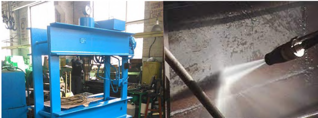
Рис. 3.22. Гідравлічний прес та абразивний струм для обробки металу
