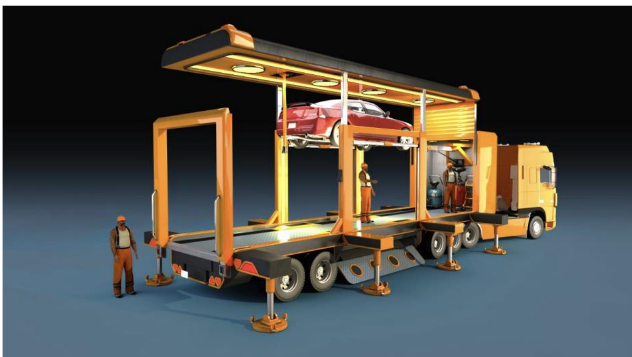
Рисунок 3.9 - Каркасна силова конструкція автосервісу ТОВ «Інвест Ізоконсалт»
