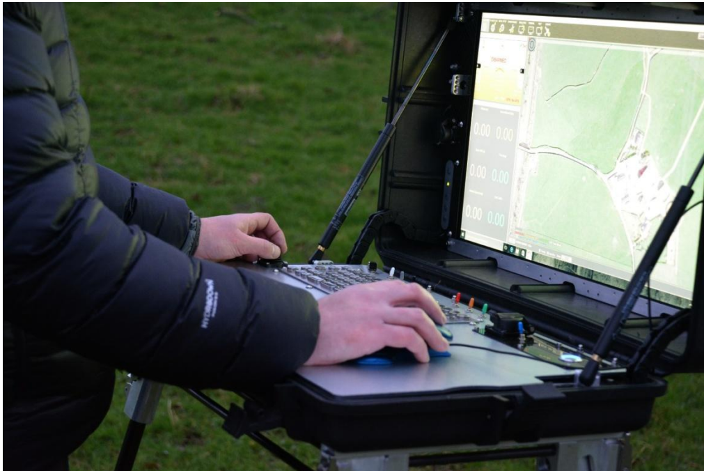
Рис 2.2 Worthington Sharpe Wing GCS - приклад портативного наземного пункту управління БПЛА (дрон GCS)
