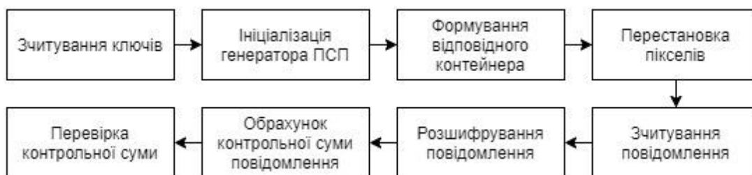
Рис. 5.1.5. Діаграма виклику основних під-функцій при зчитуванні повідомлення
