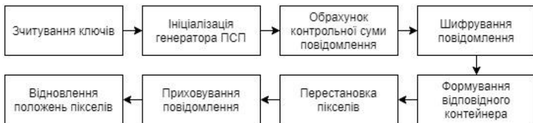
Рис. 5.1.4. Діаграма виклику основних під-функцій при приховуванні повідомлення
