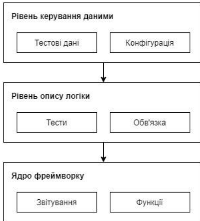
Рис. 5.3.1. Спрощена структура фреймворку для тестування
