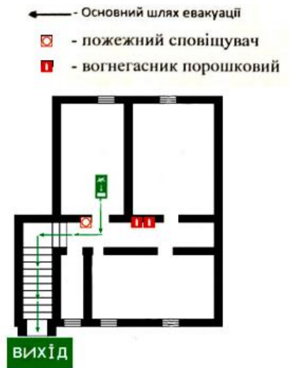
Рис.5.3. План евакуації з приміщення будівлі
