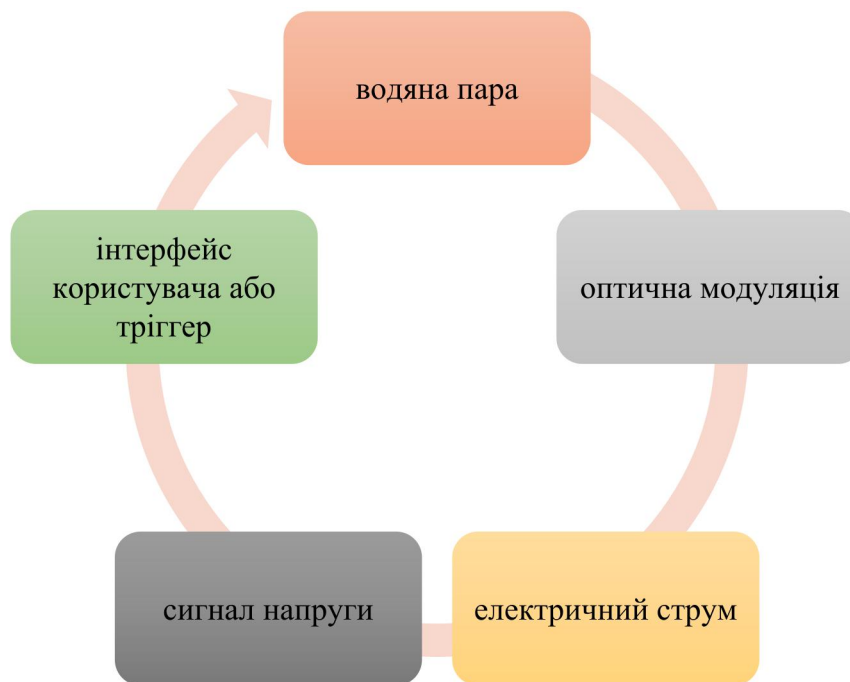
Рис. 3. Блок-схема роботи типового оптичного сенсора вологості
