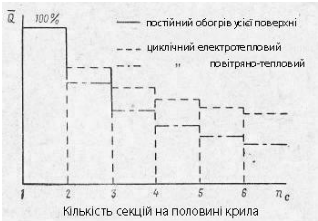
Рис. 2.10. Зменшення потрібної потужності циклічних ПОС в порівнянні з ПОС постійної дії ( n_c = 1 )
