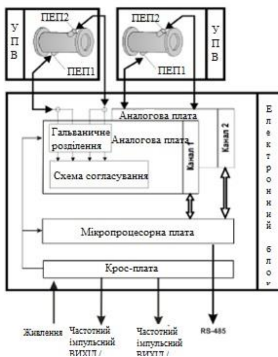
Рис. 3.2. Функціональна схема двоканального ультразвукового витратоміру
