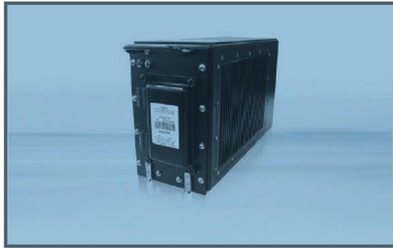
Рис. 3.9. Сервер Kontron ACE Flight 4600 має двоярусний процесор Intel Core 17 1,5 ГГц, 16 Байт DDR3 і до 1,8 Тбайт SSD. Система відповідає сучасним вимогам до продуктивності, програмного забезпечення і доступу до даних. Створена спеціально для роботи в літаку, формфактор ARINC 600 4MCU, 6 RX-каналів ARINC 429 і вбудований модем. Система енергоефективна, легка, герметична і має природне охолодження.
