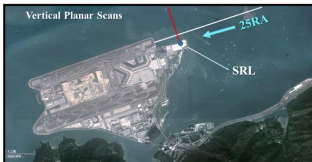
Рисунок 1.4. – Макет Лідара та північної злітно-посадкової смуги (25RA) у НКІА, де вертикальна площина сканування є суцільною лінією червоного кольору (a), і детальне налаштування Лідара (b). [9]
