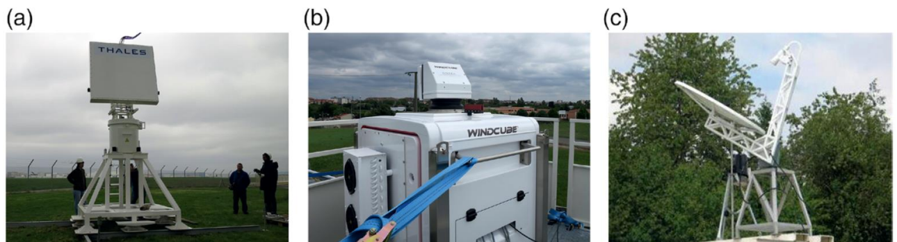
Рисунок 1.9. – Системи вимірювання в проекті UFO: а) скануючий радар Thales X-діапазону; б) скануючий лідар Leosphere і с) профільний радар CURIE X-діапазону. [18]
