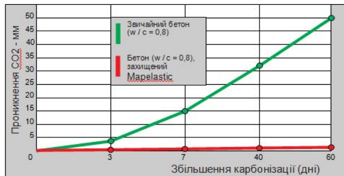
Рис. 2.3 Захист МАPELASTIC бетону від прискорення карбонізації (30 % CO 2 )
