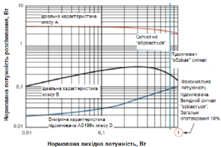
Рисунок 1.6 – Потужність розсіювання вихідних каскадів А, В та D [5]
