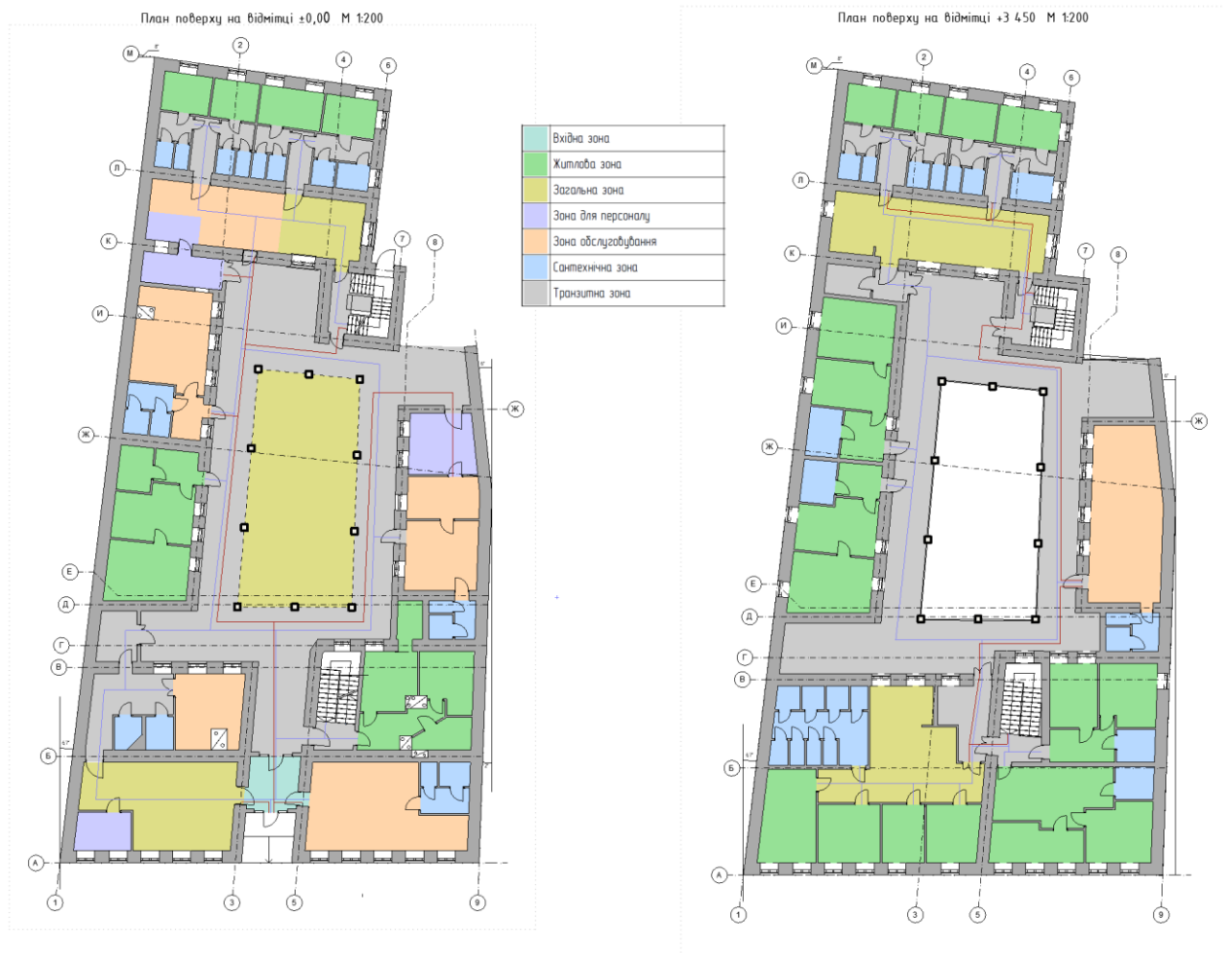
Рис. 3.7. Функціональне зонування та траєкторія руху персоналу (червона лінія) та відвідувачів (синя лінія).
