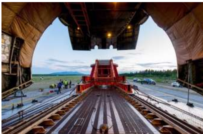
Рис. 1.13. Приклад завантаження вантажу за допомогою естакади в літак Ан-124 Руслан
