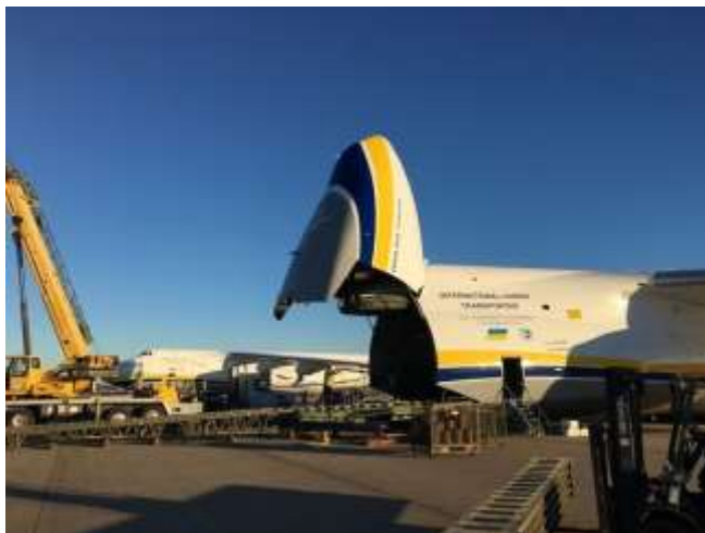
Рис. 1.12. Завантаження Ан-124 за допомогою спеціальної техніки (кранів) [28]
