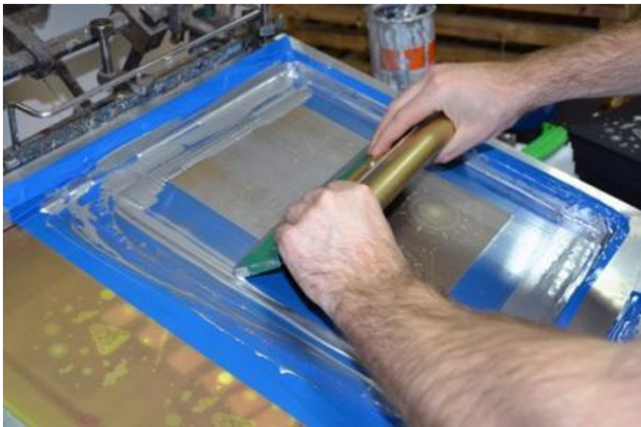
Рис. 3.5. Нанесення фарби методом шовкографії [19]
