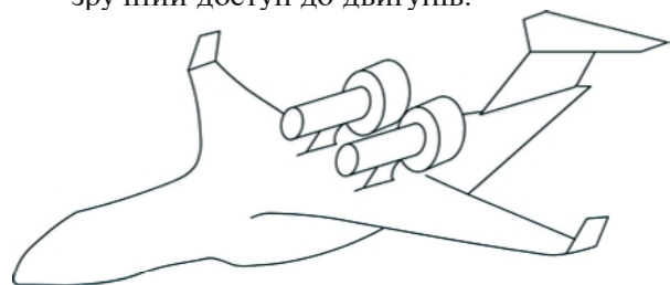
Рис. 1. Схема розташування газотурбінних двигунів з турбовентиляторною приставкою на крилі літака
