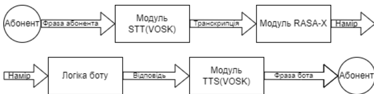
Рис. 1.1. Можлива схема роботи голосового боту на базі VOSK та RASA
