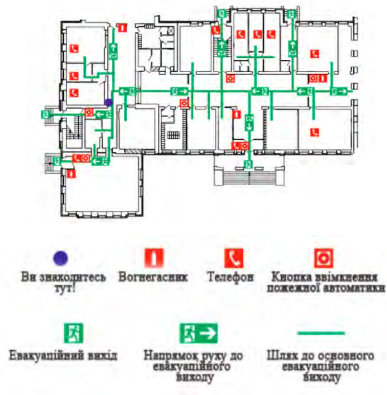
Рис.8.3. Фрагмент плану. Схема евакуації з приміщення та встановлення вогнегасника
