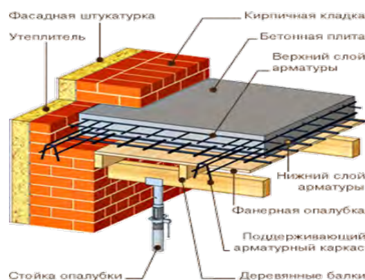
Рис. 5.1.8. Схема монолітного перекриття
