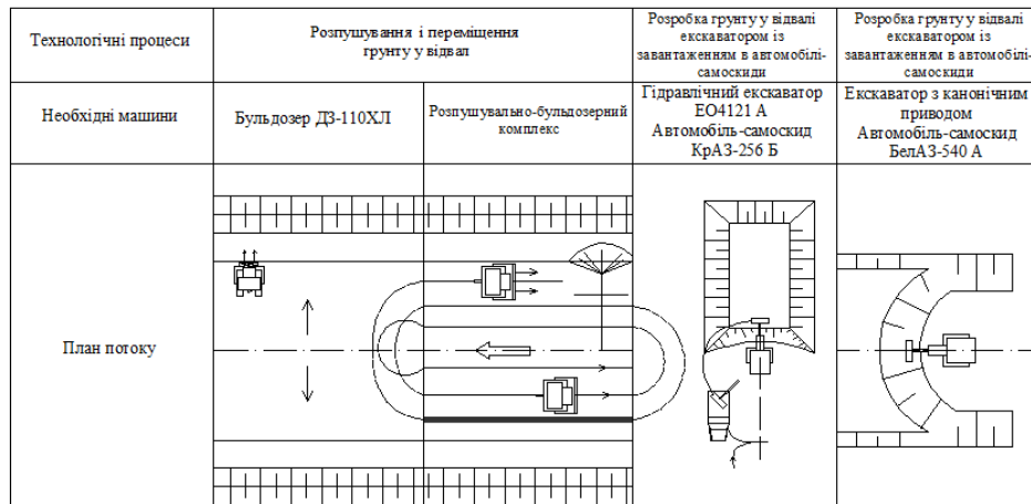
Рис.6.1 Розробка ґрунту екскаватором ЕКГ – 4 та ЕО-4121 А
