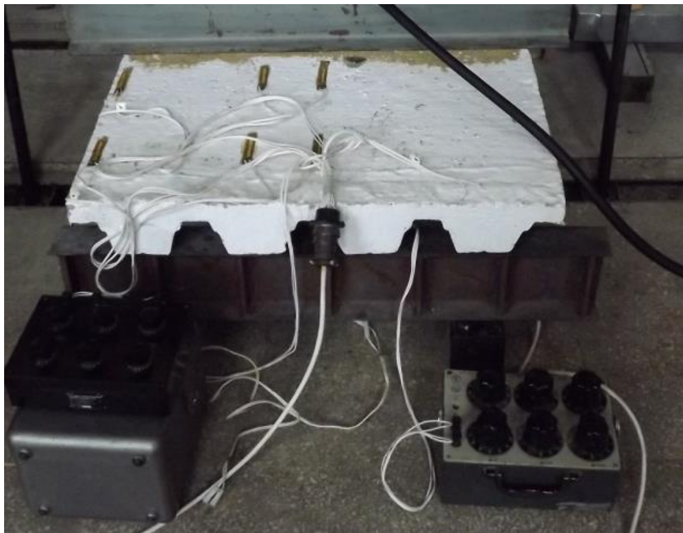
Рисунок 1.7 – Схема розміщення електротензорезисторів для елементів плит по профнастилу
