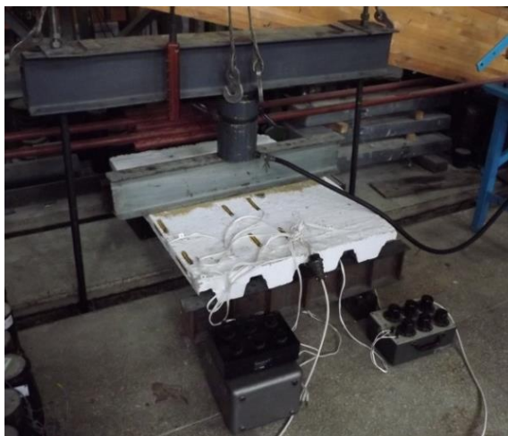
Рисунок 1.6 – Випробування елемента плит покриття по профнастилу
