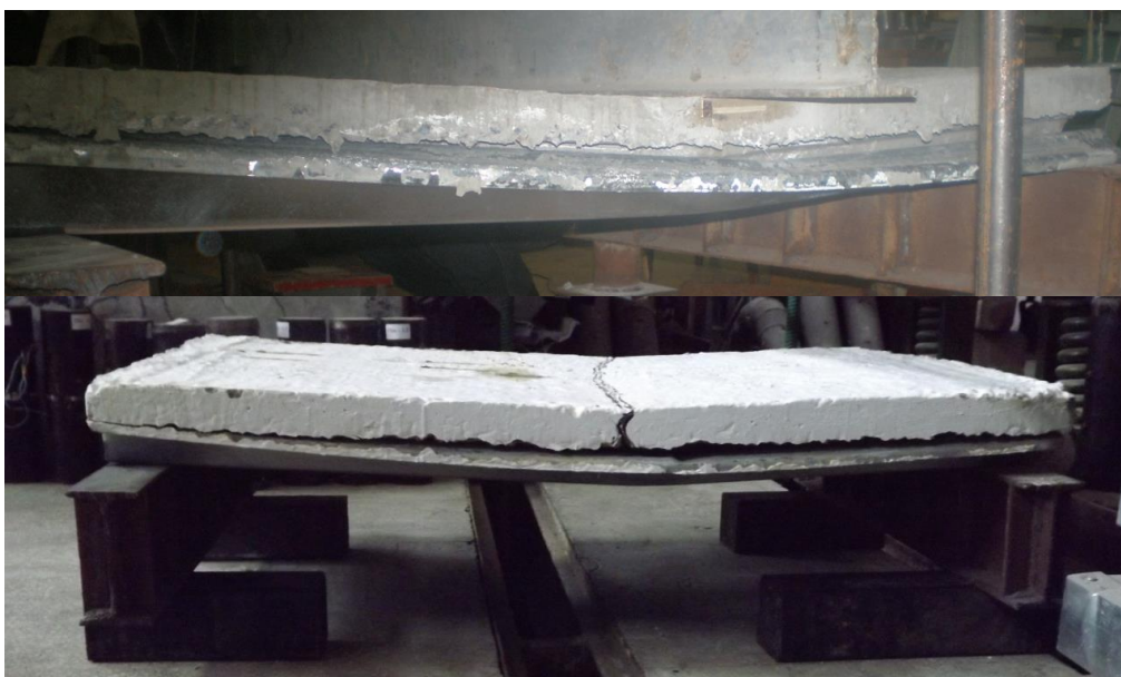
Рисунок 1.14 – Характер деформування та руйнування конструкції
