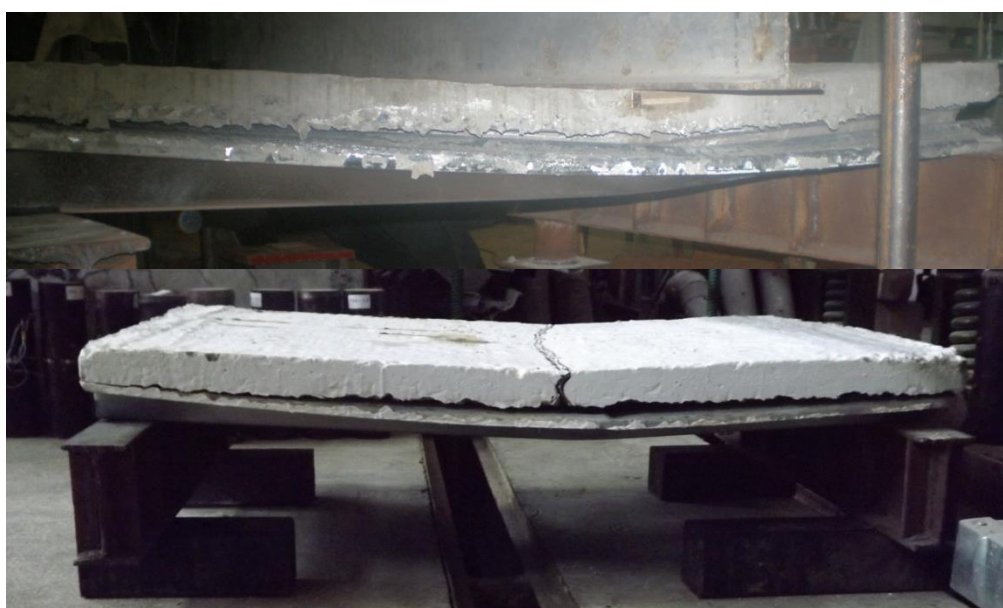
Рисунок 10.21 – Характер деформування та руйнування конструкції
