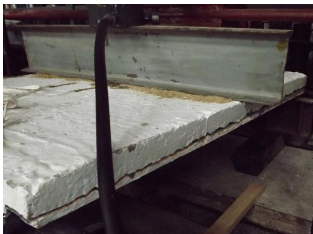
Рисунок 10.18 – Момент відриву профнастилу від бетонного блоку в зразка П3
