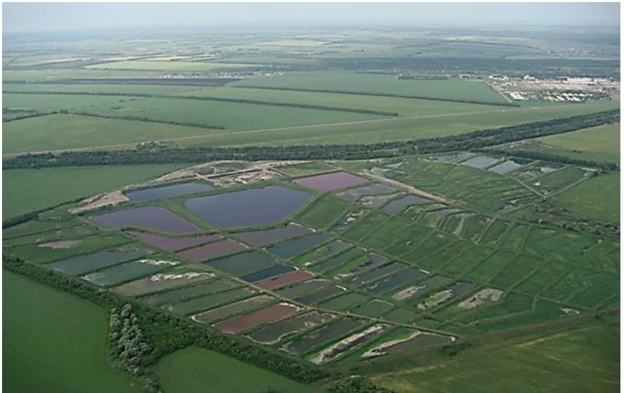
Рис. 2.2. Поля фільтрації для забруднених стічних вод
