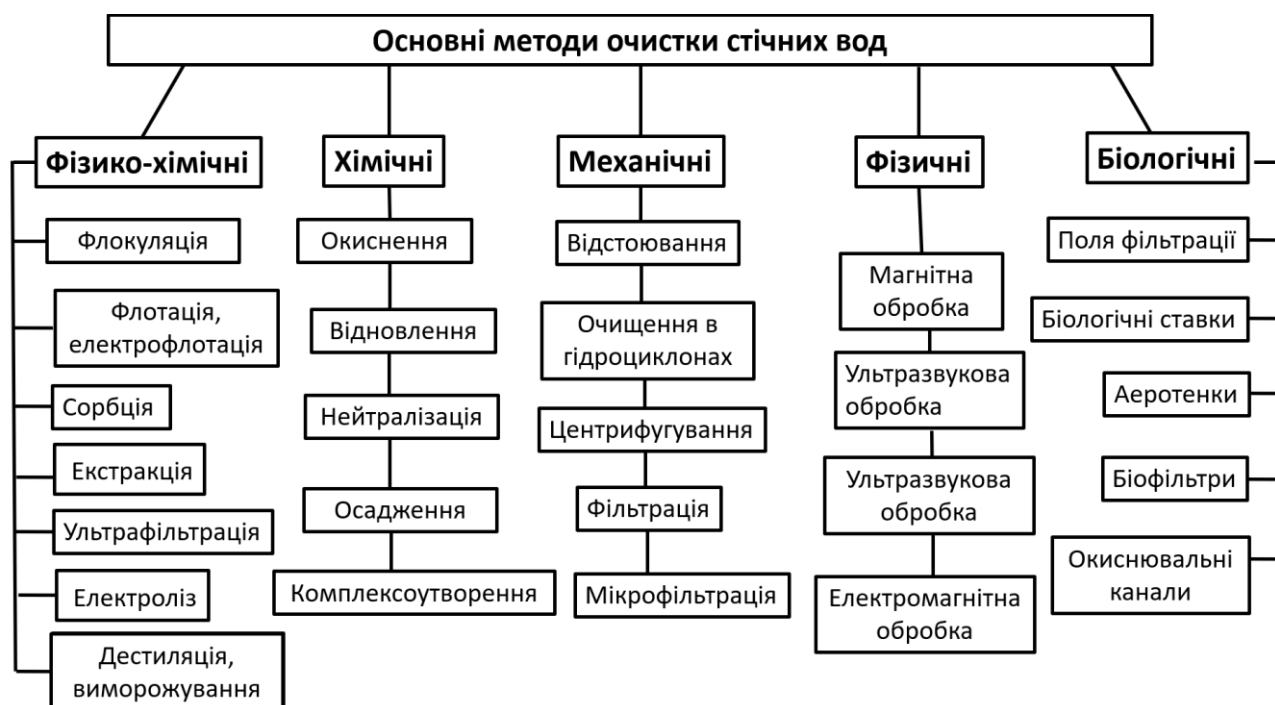
Рис. 2.1. Класифікація існуючих методів очистки стічних вод [27]
