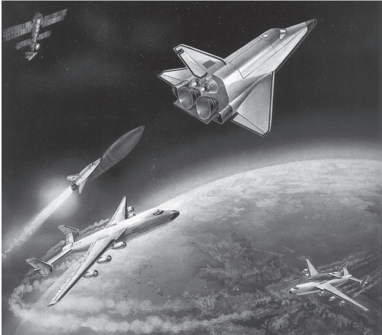
Ilustracja 54. Projekt startu promu kosmicznego „Buran”: Antonov An-225 jako platforma startowa Źródło: http://www.buran-energia.com/mriya-antonov/mriya-desc.php
