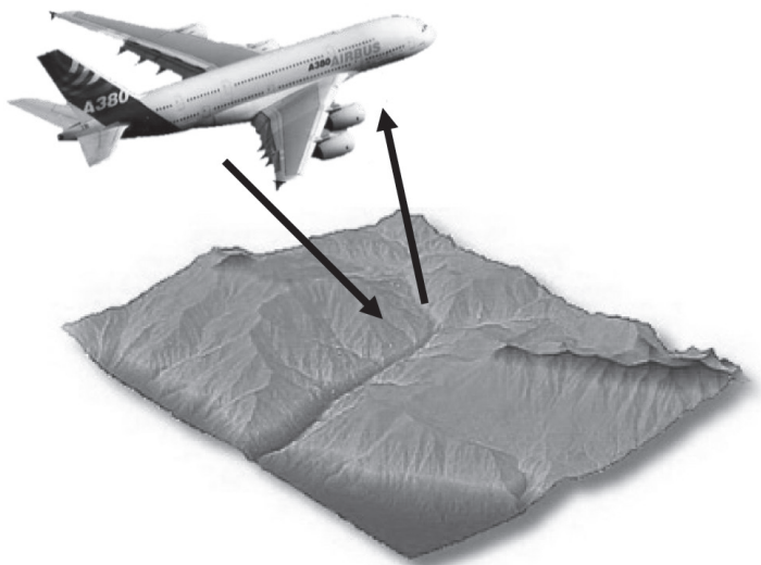
Ilustracja 113. Zasada działania systemu GPWS
