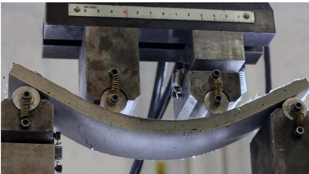
Рис. 3.4.3. Еластичний самовідновлювальний бетон
