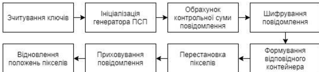
Рис. 2.2.4. Діаграма виклику основних під-функцій при приховуванні повідомлення
