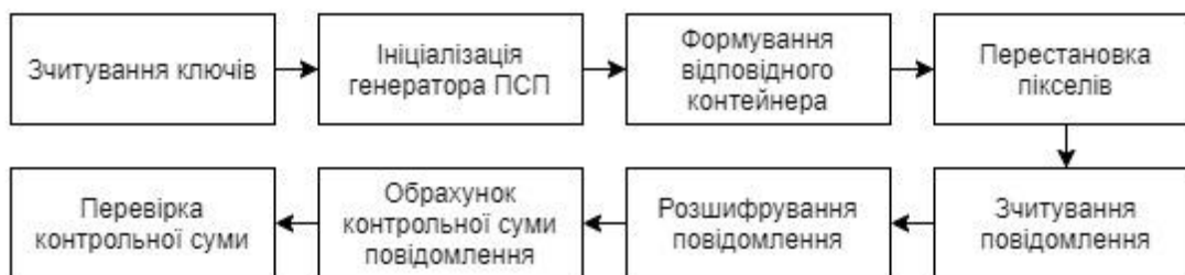
Рис. 2.2.5. Діаграма виклику основних під-функцій при зчитуванні повідомлення
