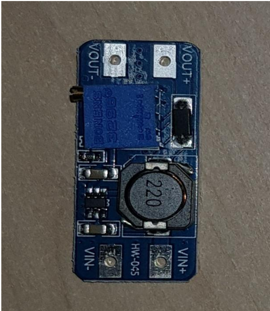
Рис.3.7. Мініатюрний регульований підвищуючий перетворювач (MT 3608).
