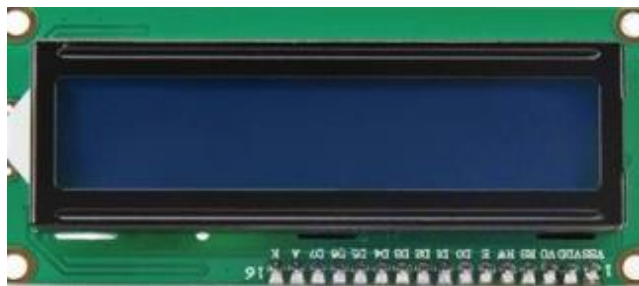
Рис. 2.6 - Вигляд РК-дисплей (16X2 символічний)
