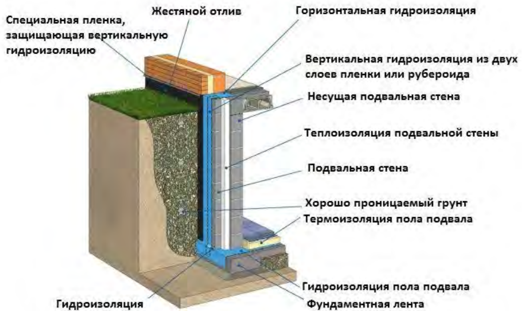
Рис. 2.3 Схема гідроізоляції фундаменту
