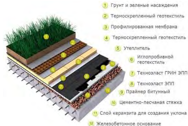
Рис 2.11 Влаштування конструкції зеленої покрівлі
