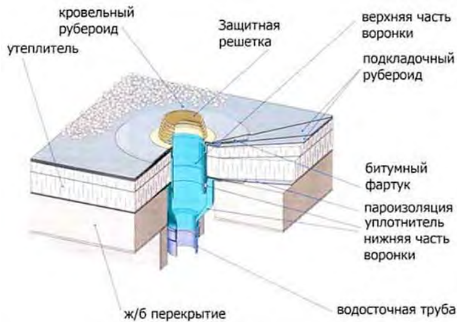
Рис. 2.12 Влаштування конструкції водостоку
