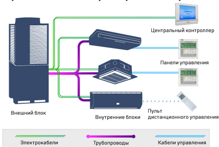
Рис.2.36. Принципова схема поєднання ключових елементів системи VRV
