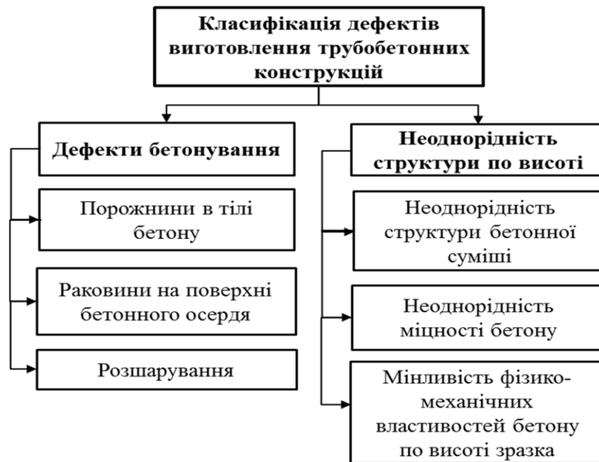
Рис.1.5. Класифікація дефектів осердя трубобетонних конструкцій
