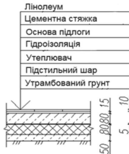
Рис.2.4. Вузол підлоги у службових приміщеннях
